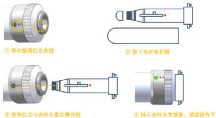
图 2-3 QBH 与光纤连接方法
