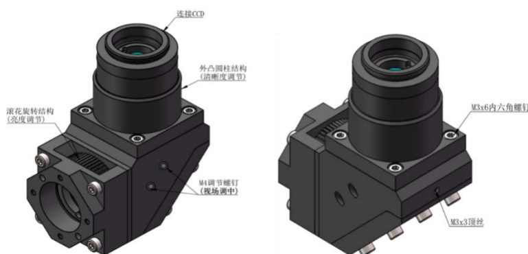
图 2-4 BW240 CCD 调节方法
