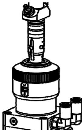
图 3.4 — QBH 接口插光纤示意图
