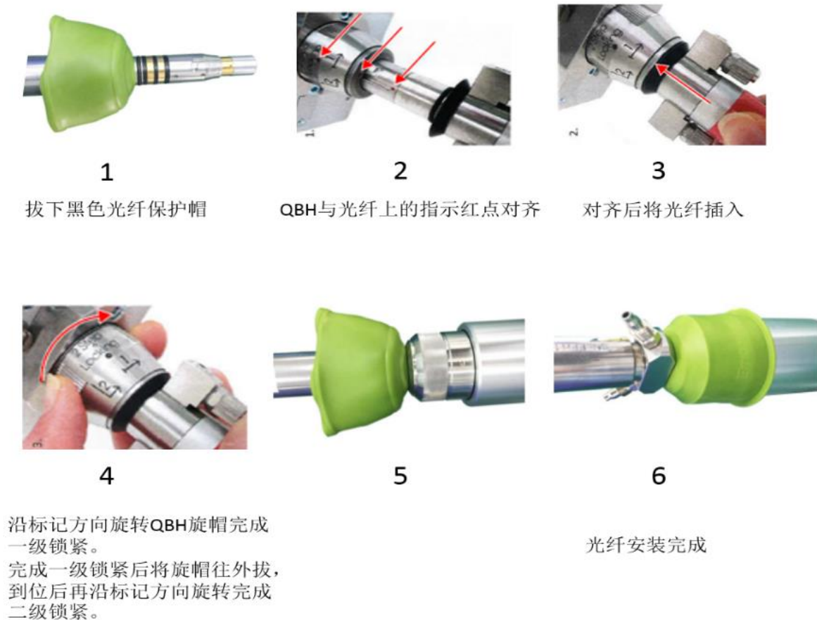
图 6 QBH 与光纤连接方法
